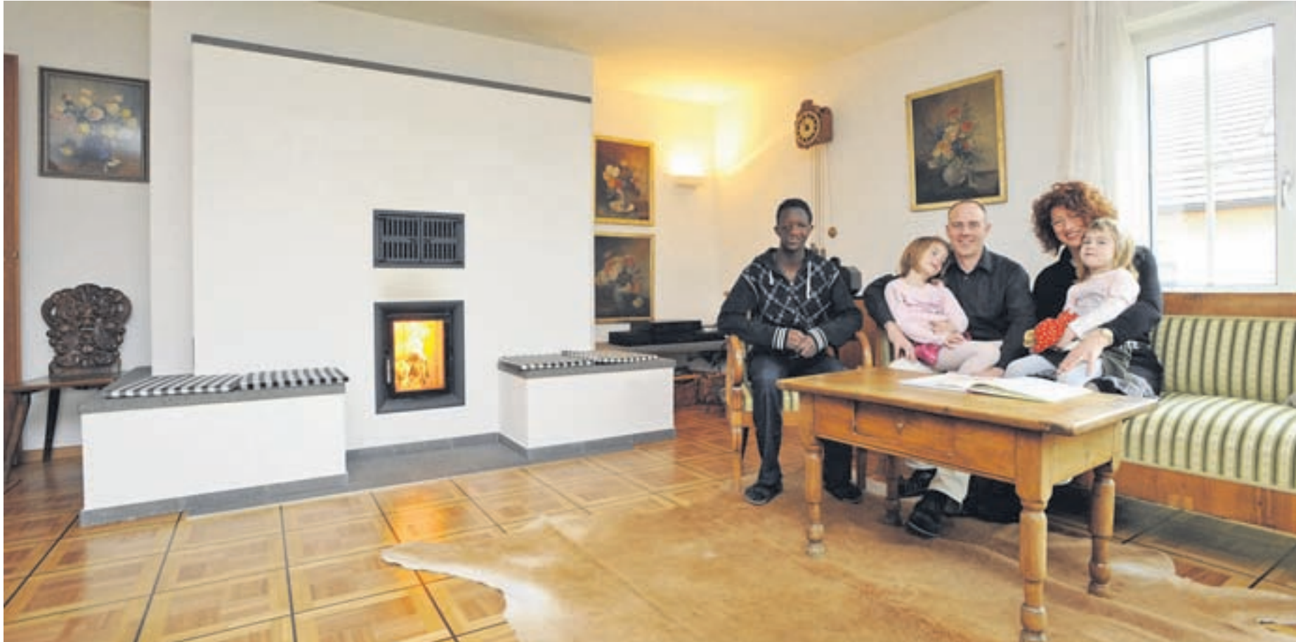
Wohlige Wärme – niedrige Kosten. Der moderne vollautomatisierte Kachelofen der Familie Kaspar und Tina Strub in Arisdorf mit grossem Speicher im Keller, kombiniert mit Solarmodulen und Pelletheizung. Foto Dominik Plüss
